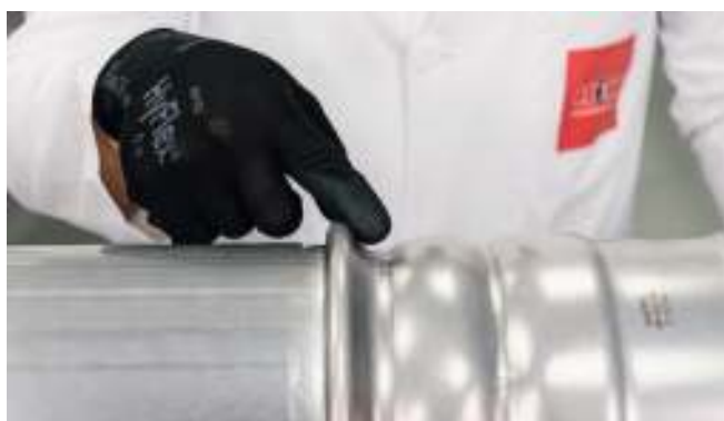
Рис. 36. Визуальный осмотр места прессования Oversize.
